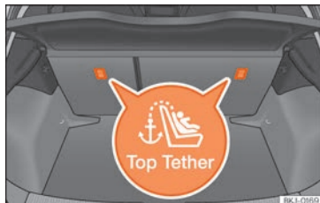
Fig. 39 Position des anneaux Top Tether sur la partie arrière de la banquette arrière.
