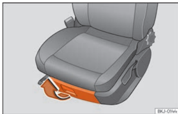
Fig. 156 Rangement sous le siège avant droit.
