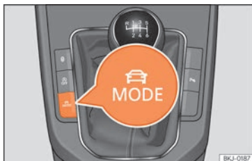
Fig. 243 À côté du levier de vitesses : touche MODE .
