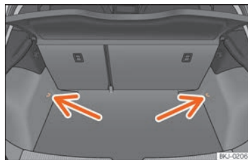
Fig. 165 Emplacements des œillets d'amarrage dans le coffre à bagages.
