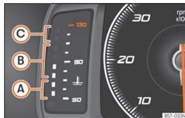
Fig. 124 Tableau de bord numérique : indicateur de température du liquide de refroidissement du moteur.
