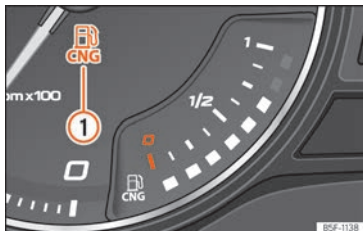
Fig. 122 Tableau de bord analogique : indicateur du niveau de gaz naturel
