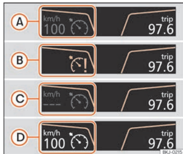
Fig. 227 Afficheur de combiné d'instruments indications d'état du GRA.
