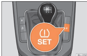
Fig. 274 Console centrale : touche du système de contrôle de la pression des pneus.
