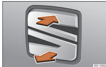
Fig. 8 Hayon : ouverture de l'extérieur.
