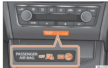
Fig. 26 Sur le tableau de bord, au centre : témoin de désactivation de l'airbag du passager avant.
