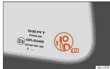
Fig. 89 Étiquette d'avertissement de la position de l'appuie-tête.
