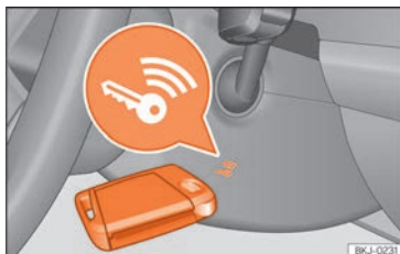
Fig. 218 À droite de la colonne de direction : démarrage d'urgence.
