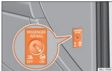
Fig. 96 Commande à clé permettant d'activer et de désactiver les airbags du passager avant.
