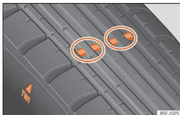
Fig. 272 Sculptures du pneu : indicateurs d'usure.
