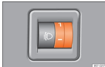
Fig. 145 Planche de bord : dispositif de réglage de la portée des phares.
