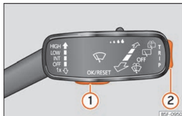
Fig. 125 Levier d'essuie-glace : touches de contrôle.
