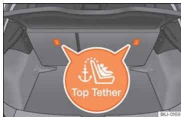
Fig. 35 Position des anneaux Top Tether sur la partie arrière de la banquette arrière.
