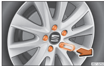
Fig. 73 Roue : boulons de roue avec capuchons.
