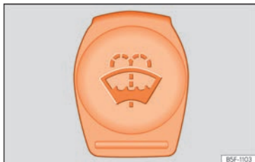
Fig. 63 Dans le compartiment moteur : bouchon du réservoir de liquide lave-glace.
