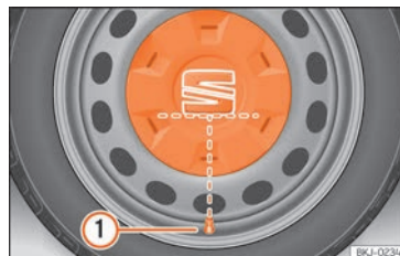
Fig. 71 Placement correct de l'enjoliveur central de roues pour jantes en acier.
