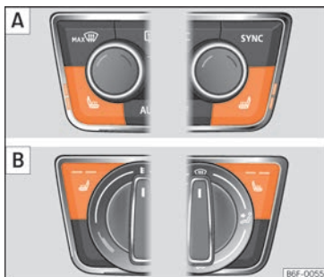
Fig. 151 Dans la console centrale : commandes du chauffage des sièges avant. [A] : version avec Climatronic. [B] : version avec climatiseur manuel.
