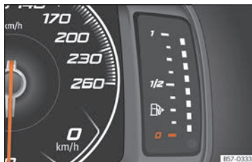
Fig. 121 Tableau de bord numérique : indicateur du niveau de carburant.
