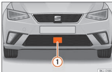
Fig. 232 Au niveau du pare-chocs avant : capteur radar.
