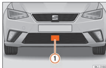
Fig. 237 Au niveau du pare-chocs avant : capteur radar.
