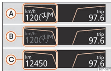
Fig. 228 Sur l'écran du combiné d'instruments : indications de l'état du limiteur de vitesse.
