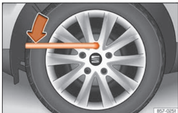
Fig. 74 Changement de roue : desserrer les vis de roue.
