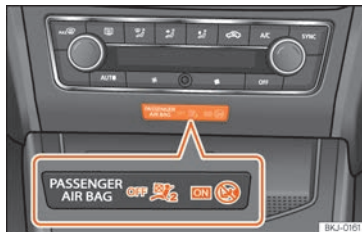
Fig. 97 Sur le tableau de bord, au centre : témoin de désactivation de l'airbag du passager avant.
