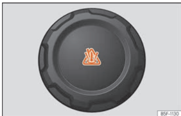
Fig. 61 Compartiment-moteur : bouchon du vase d'expansion du liquide de refroidissement.
