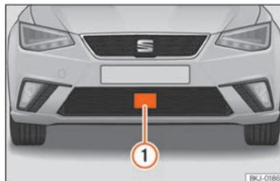
**Fig. 232** Au niveau du pare-chocs avant : capteur radar.
