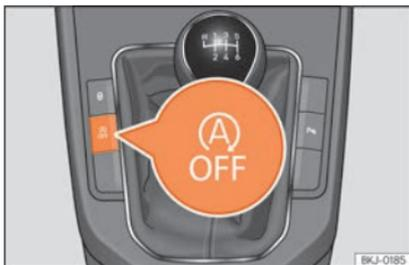
**Fig. 226** Console centrale : touche du système Start-Stop.
