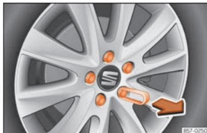
**Fig. 73** Roue : boulons de roue avec capuchons.
