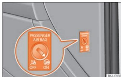
**Fig. 25** Commande de l'airbag frontal du passager.
