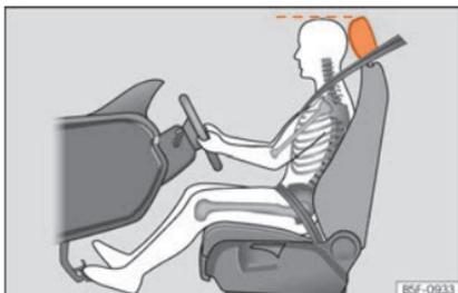
**Fig. 86** Position correcte de l'appui-tête du conducteur
