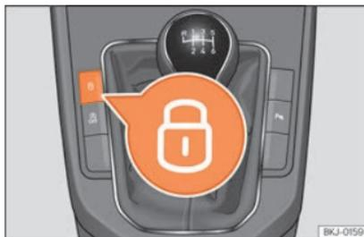
Fig. 134 Touche de verrouillage centralisé.
