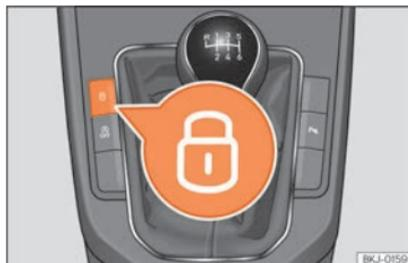
**Fig. 5** Console centrale : touches de verrouillage centralisé.
