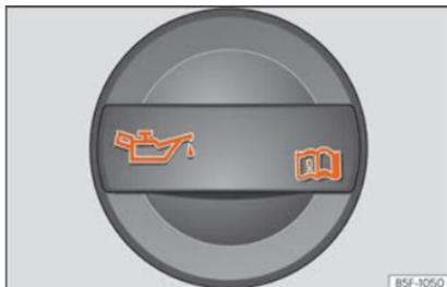
Fig. 60 Dans le compartiment-moteur : bouchon de l'orifice de remplissage d'huile moteur.
