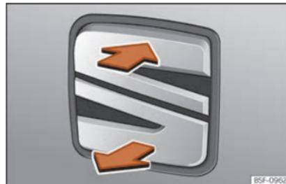
**Fig. 8** Hayon : ouverture de l'extérieur.
