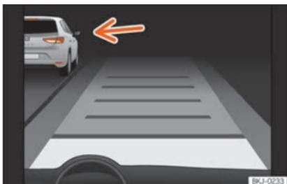
**Fig. 240** Sur l'écran du combiné d'instruments : ACC activé, véhicule circulant à gauche détecté
