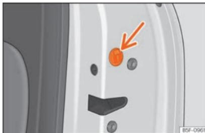
**Fig. 7** Verrouillage d'urgence de la porte.
