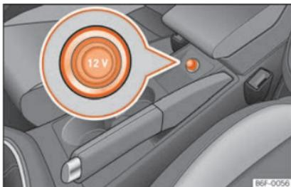
**Fig. 160** Prise de courant avant.
