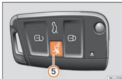
Fig. 131 Clé du véhicule avec bouton d'alarme.
