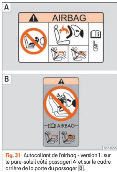
**Fig. 31** Autocollant de l'airbag - version 1 : sur le pare-soleil côté passager **A** et sur le cadre arrière de la porte du passager **B**.
