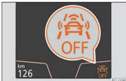
Fig. 233 Sur l'écran du combiné d'instruments : indication de Front Assist désactivé.
