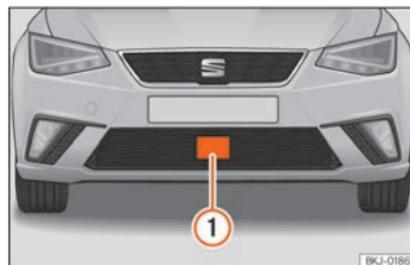
**Fig. 237** Au niveau du pare-chocs avant : capteur radar.
