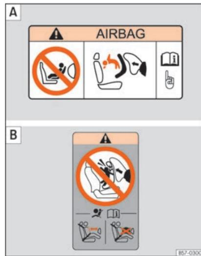
**Fig. 32** Autocollant de l'airbag - version 2 : sur le pare-soleil côté passager **A** et sur le cadre arrière de la porte du passager **B**.
