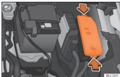
**Fig. 65** Dans le compartiment moteur : cache du boîtier de fusibles.
