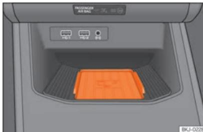
**Fig. 215** Console centrale : Connectivity Box
