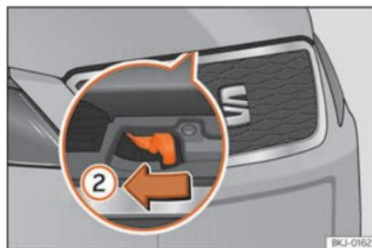
**Fig. 12** Levier sous le capot.
