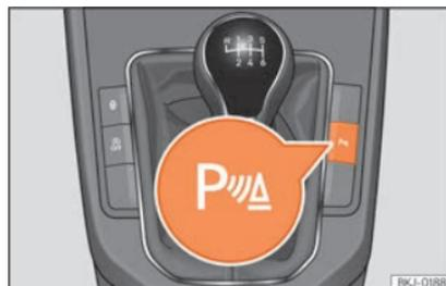
Fig. 245 Console centrale : touche de l'aide au stationnement (en fonction des versions).
