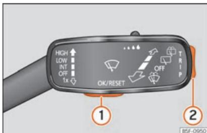
**Fig. 125** Levier d'essuie-glace : touches de contrôle.
