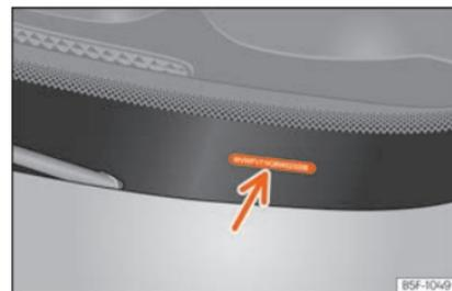
Fig. 276 Numéro de châssis.
