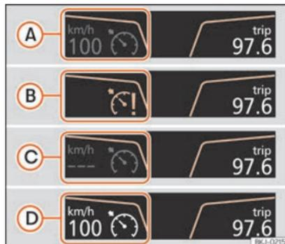
**Fig. 227** Afficheur du combiné d'instruments indications d'état du GRA.
