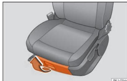
**Fig. 156** Rangement sous le siège avant droit.
